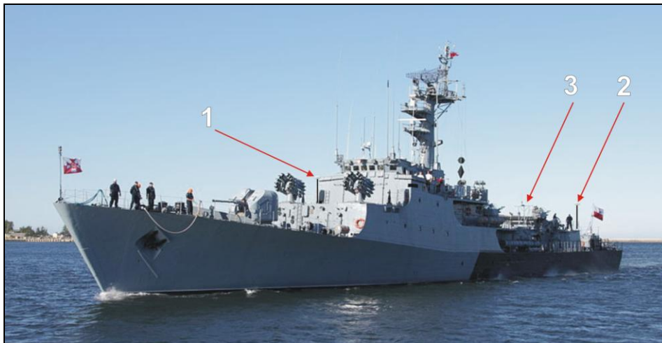
Rys.7. Miejsce montażu anten na okręcie
