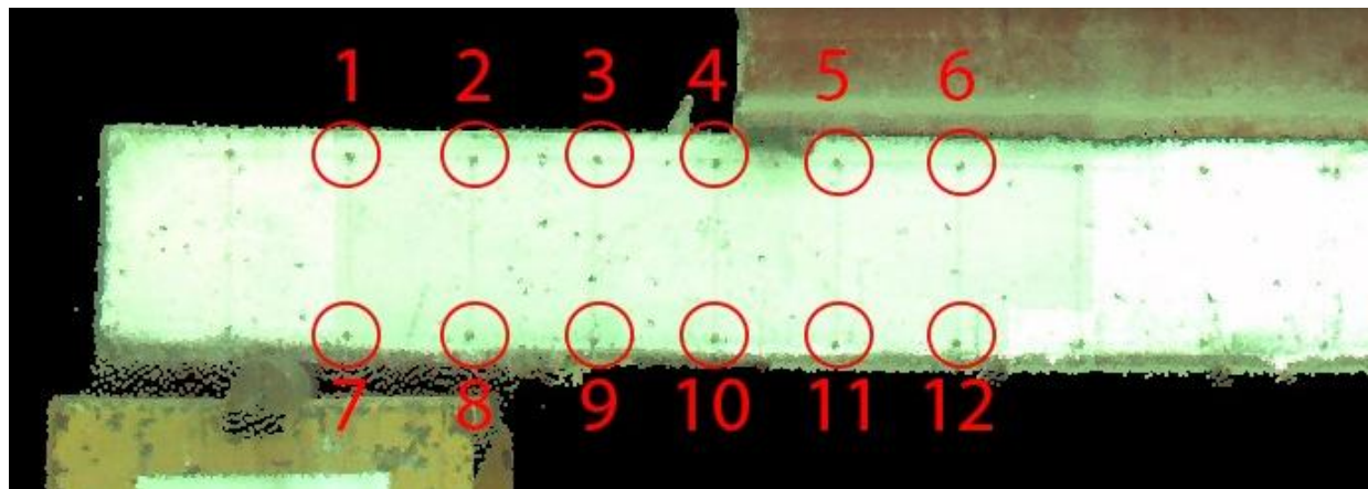
Rys. 5. Sygnalizowane punkty wykorzystane w metodzie translacji sfer. Obraz na skanie pozyskany w ramach eksperymentu
